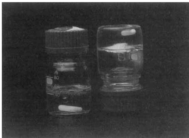
Abb. 14. Ein Mikroemulsions- oder Brummigel mit Stahlkugeln, die in ihm suspendiert sind.
